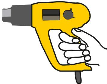
**3.** En los lugares donde el vinilo debe estirarse sobre el objeto, la lámina se calienta con una pistola de calor para que el vinilo se vuelva flexible. Cuando el vinilo se calienta, se le da forma o se tira con cuidado sobre el elemento de ensamblaje.
