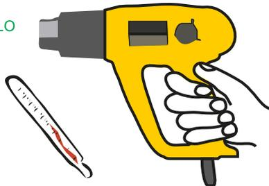
**5.** Cuando se complete la instalación, el vinilo debe recalentarse a aprox. 95 grados °C, para que el vinilo "olvide" su forma original. Si el vinilo no recibe este poscalentamiento, muy lentamente volverá a su forma original..
